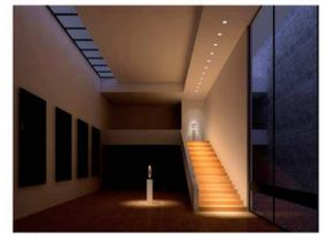
Der gleiche Raum bietet Möglichkeiten, die hintere Wand zu gestalten, die Stelen zu beleuchten. Mit Licht in einem Punkt wird im Gegensatz zum Flutlicht, gebündeltes Licht erzeugt. Die vertikalen Treppe bildet das Wegweiser in die überflutete Deckenfläche.
