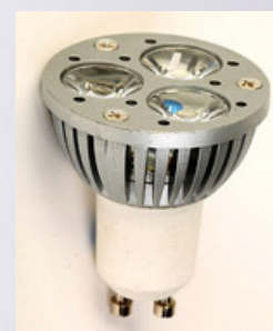
LED-Lampe mit 3 x 1W-Hochleistungs-LED's mit Sockel GU10: entspricht in etwa einer Glühlampe von 25W, wirkt aber stärker, da gezieltes Licht (Spot oder Flood) mit anderer Licht-Charakteristik
